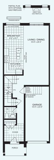
GROUND FLOOR PLAN ELEVATION A1
